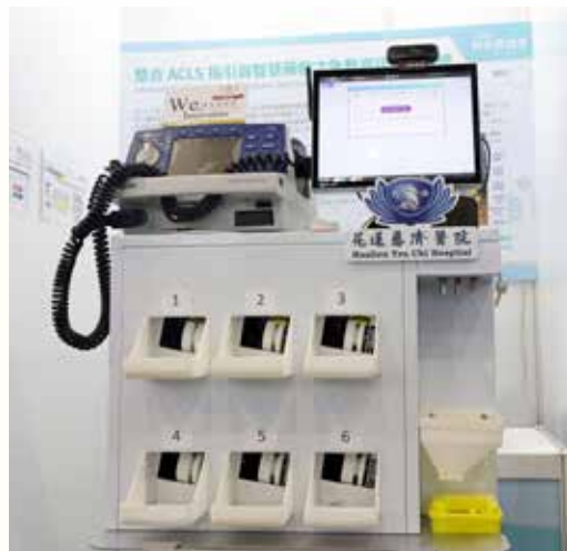
急救智慧醫療車整合 ACLS 資訊系統、臨床生理監測與智慧藥櫃，不僅能幫助醫護人員用藥與交接，也能依據病人當下的情況，自動給予急救團隊最佳化的處置流程。
